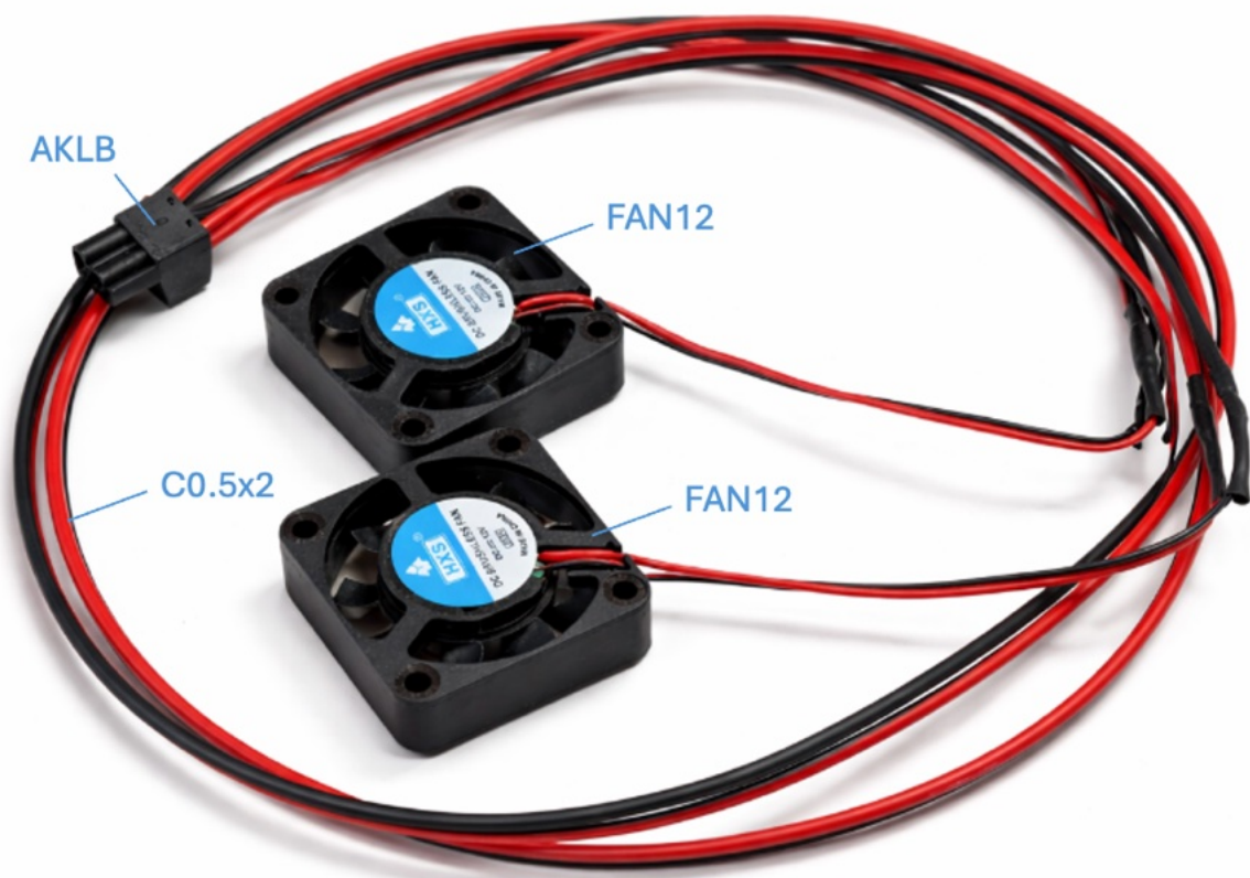
Abbildung 32 Lüftermodul mit 2 x FAN12 und verlängerten Leitungen an Steckerbuchse AKLB.
